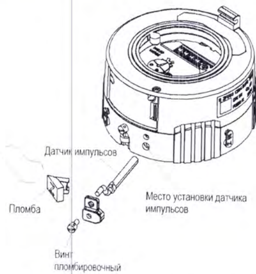
Рисунок 3.4 – Схема пломбировки датчика импульсов от несанкционированного доступа
