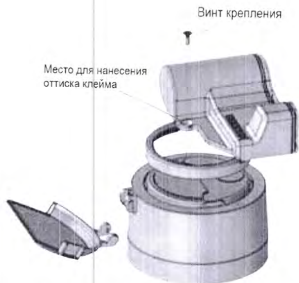
Рисунок 3.3 – Схема пломбировки EDC-модуля от несанкционированного доступа
