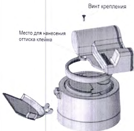
Рисунок 3.3 – Схема пломбировки EDC-модуля от несанкционированного доступа
